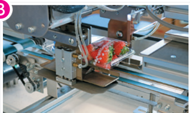
③パック搬送ラインで運ばれ、自動セロハン機でフィルムを被せる
